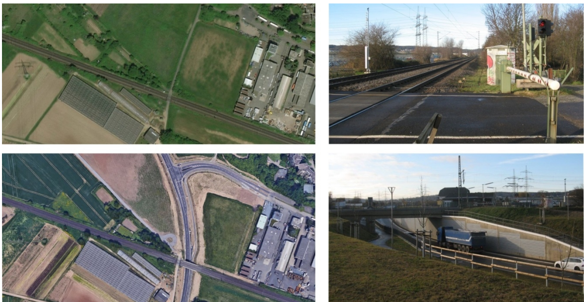
Abbildung 9 Luftbilder (links) einer Kreuzung zwischen Bahn (Strecke 2630 Köln – Bonn) und Straße nördlich der Stadtgrenze von Bonn-Tannenbusch als beschränkter Bahnübergang (Rheinweg – Bilder oben) und als Unterführung (L183n – Bilder unten) (Quelle Luftbilder: Bing Maps und Google Earth Pro)
