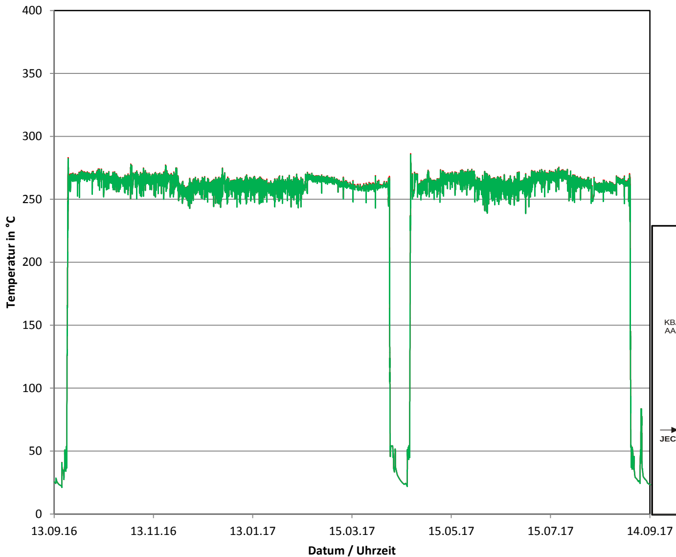
Betriebszyklus 2016/2017 Temperaturen am Einspeiseaustrittsstutzen des REKU KBA12BC001
