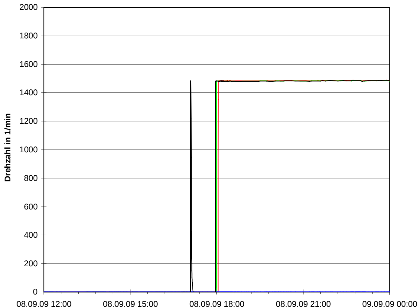
Anfahren nach der Revision 2009 Drehzahlen Hauptkühlmittelpumpen
