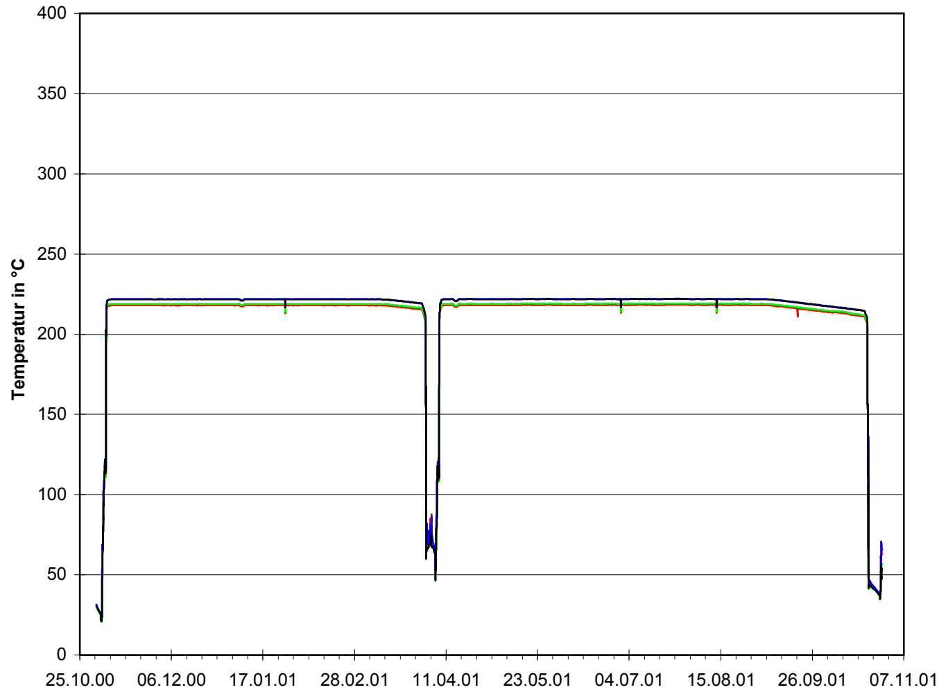
Temperaturen im Bereich des Sonderformstücks LAB40/45/50
