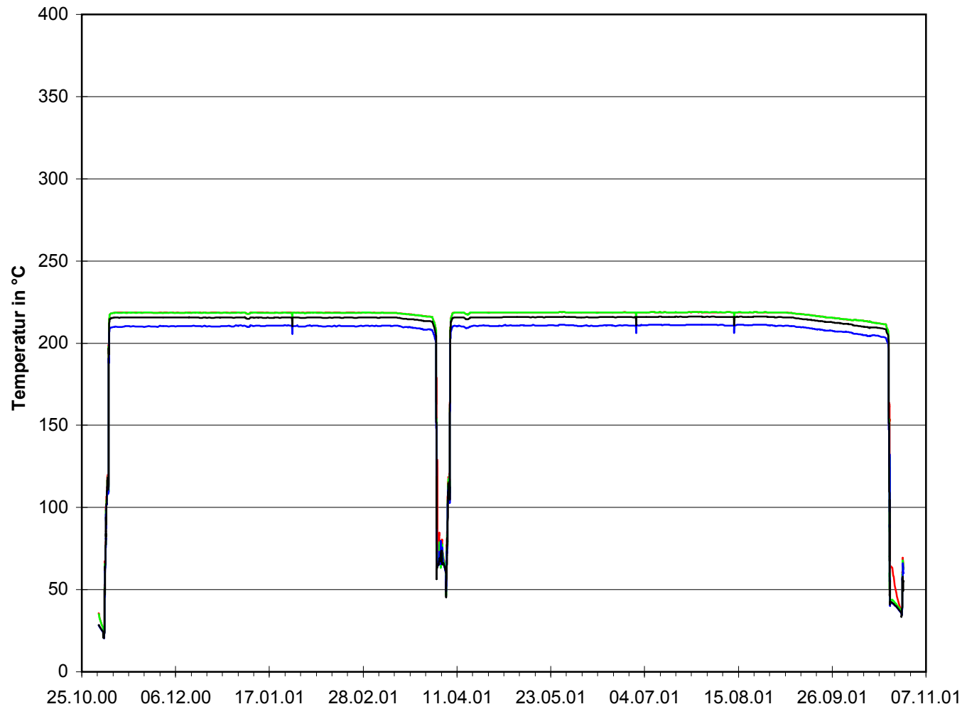
Temperaturen im Bereich des Sonderformstücks LAB40/45/50
