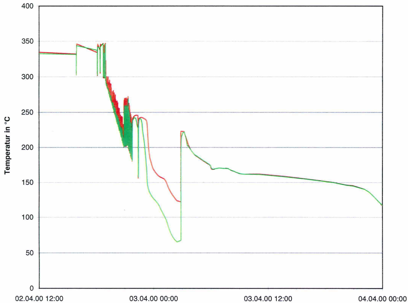
Temperaturen an Sprühleitung JEF10BR350 am Bogen bei Sprühstutzen H3
