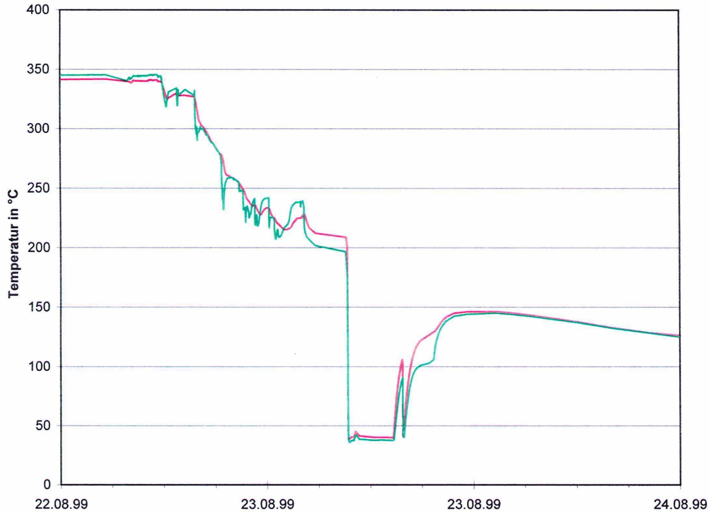
Temperaturen an der Hilfssprühleitung KBA10BR005 am Bogen bei Hilfssprühstutzen H4
