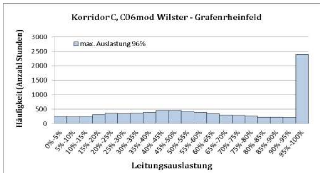
Abbildung 13: Histogramm der relativen Auslastung der Maßnahme C06mod. über 8760 h
