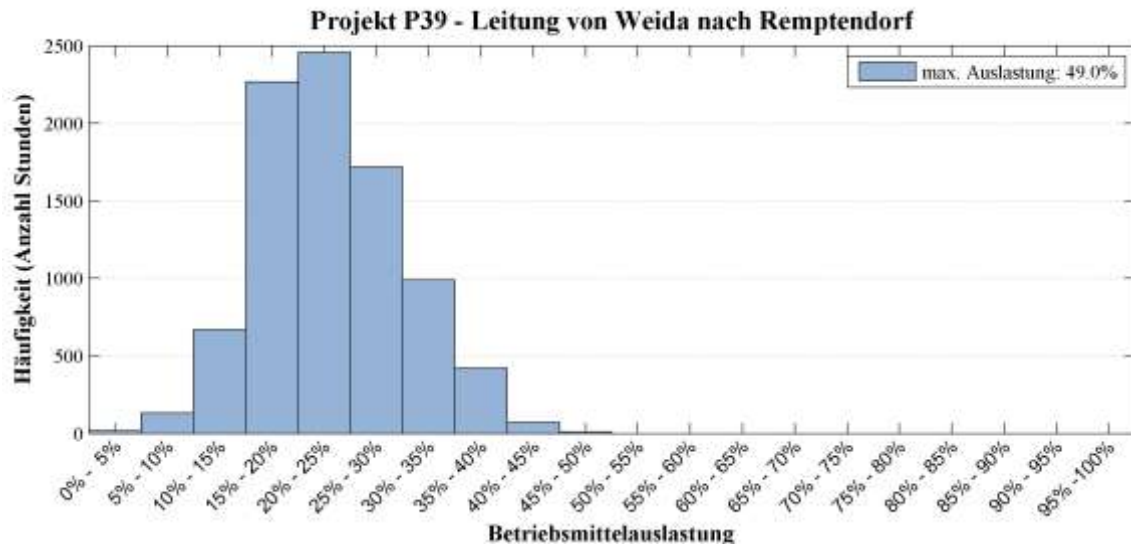
Abbildung 89: Histogramm der relativen Auslastung der im Rahmen der Alternative 1 neu gebauten Leitung von Weida nach Remptendorf
