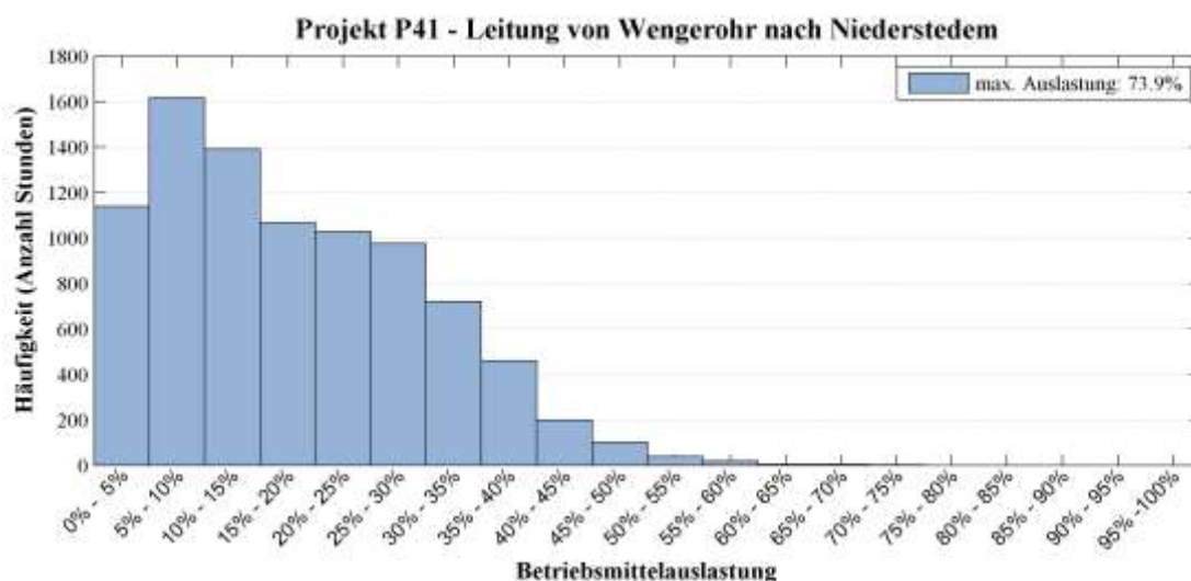
Abbildung 93: Histogramm der relativen Auslastung der existierenden 220-kV-Leitung von Wengerohr nach Niederstedem bei Realisierung der Alternative
