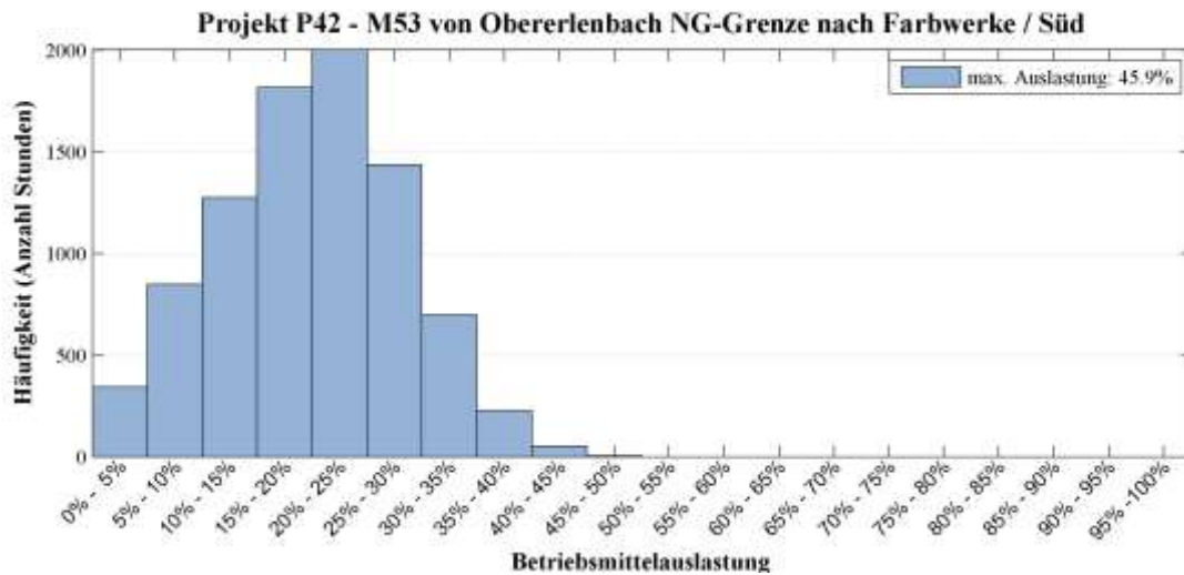
Abbildung 96: Histogramm der relativen Auslastung der Maßnahme M53 von Obererlenbach zu den Farbwerken Höchst-Süd über 8760 h
