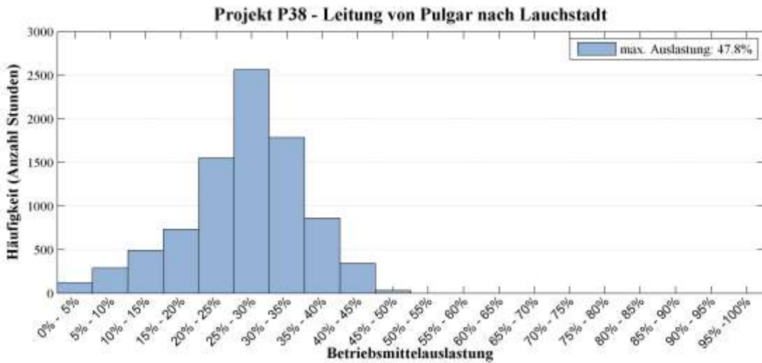
Abbildung 86: Histogramm der relativen Auslastung der Alternative über 8760 h
