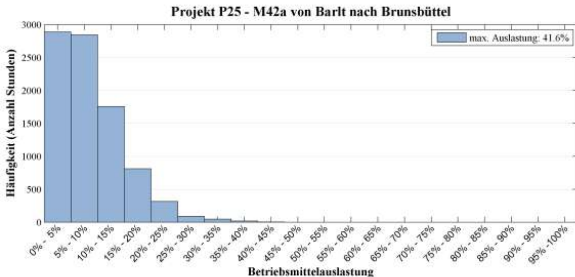
Abbildung 48: Histogramm der relativen Auslastung der Maßnahme M42a über 8760 h
