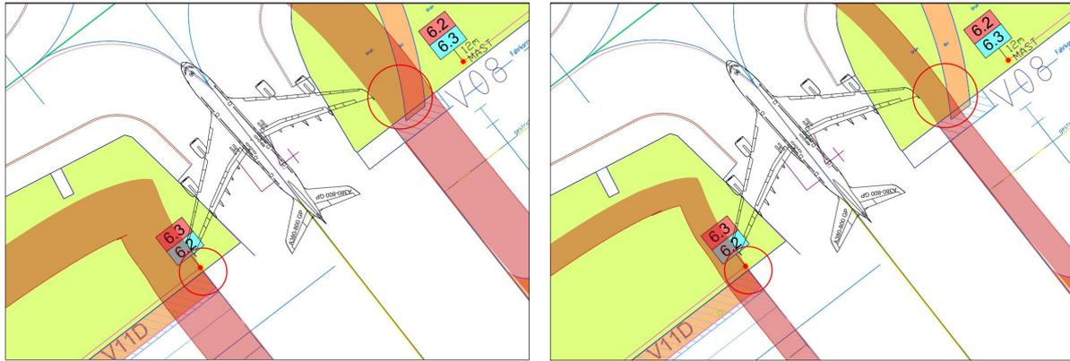
Abbildung 21: Unterschreitung ICAO/EASA Mindestabstand (links) und AACG Mindestabstand (rechts) an der Rollbahn L4
