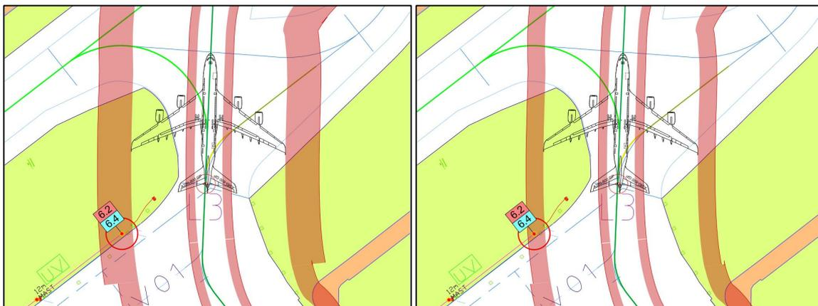
Abbildung 22: Unterschreitung ICAO/EASA Mindestabstand (links) und AACG Mindestabstand (rechts) an der Rollbahn L3
