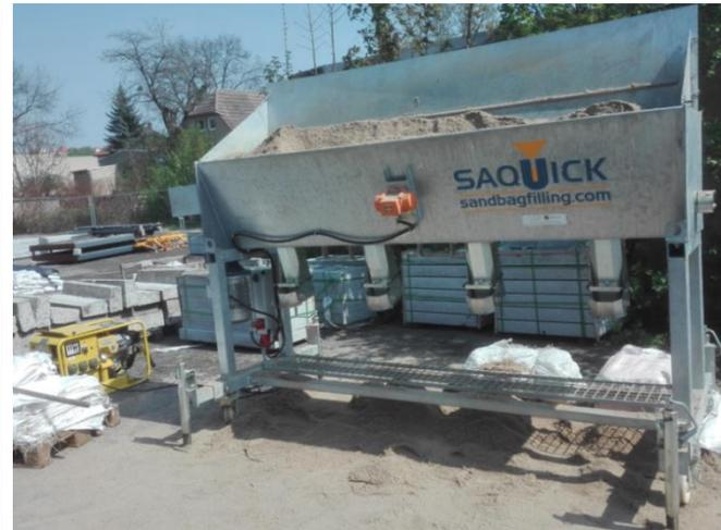
Befüllmaschinen, aber Versagensgefahr bei feuchtem Sand
