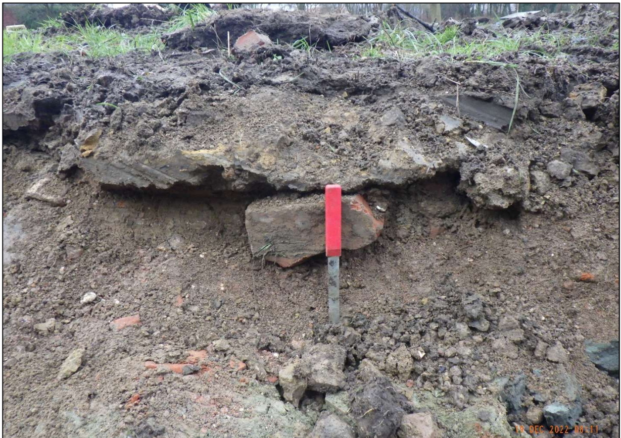
Abb. 3: Oberbodenhorizont mit zwischen 3 u. 10 cm schwankenden Mächtigkeiten über Altablagerung
