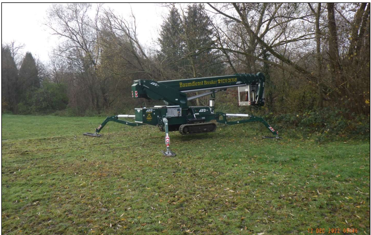
Abb. 2: Hubsteiger auf Kettenlaufwerken
