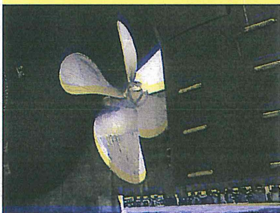
Fig.6: Schiffsschraube, Schiffshülle und Ruder stellen eine komplizierte, zeitvariante Elektrodenanordnung dar.
