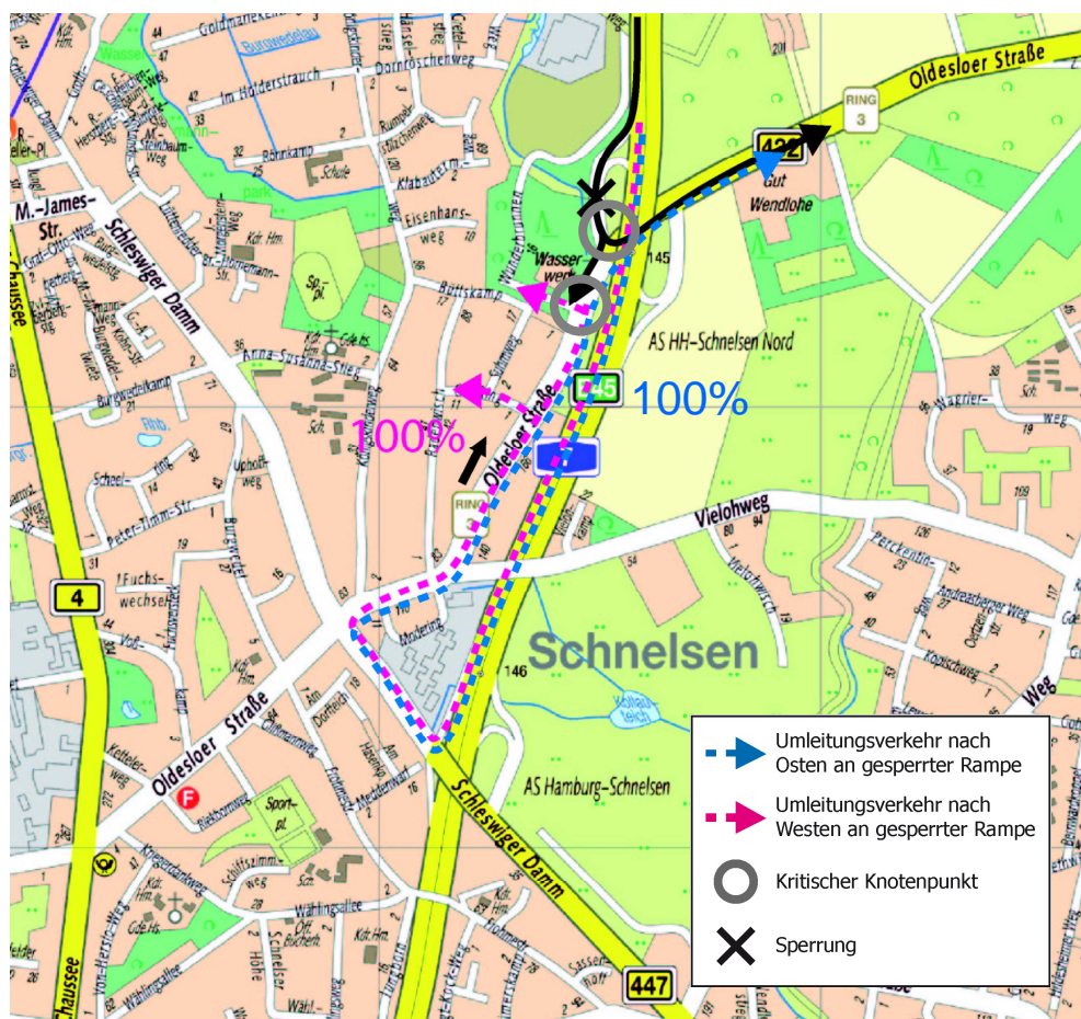
Abbildung 3: Umleitungstrecke bei Sperrung AS HH-Schnelsen-Nord – Westrampe
