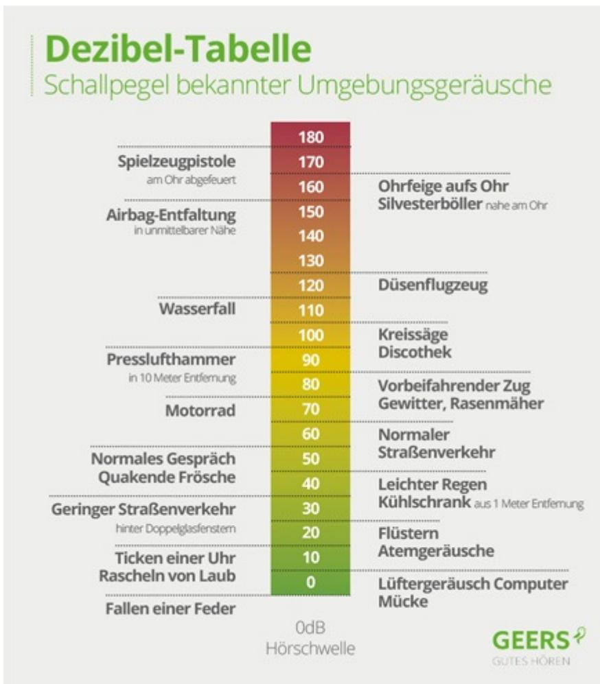
Ab 40 dB kann der Geräuschpegel zu Einschränkungen der Konzentration führen. Bei einem Raumvolumen von 400 m<sup>3</sup> (entspricht ca. einem Raum mit 70 m<sup>2</sup> und 2,80 m Raumhöhe) wird dieser Wert nur bei zweifachem Luftwechsel pro Stunde und in einem Meter Abstand erreicht. Wird die Luftwechselrate auf drei erhöht (normale Luftwechselrate von stationären Lüftungsanlagen), erhöht sich auch der Schallpegel bereits auf 47 dB.
