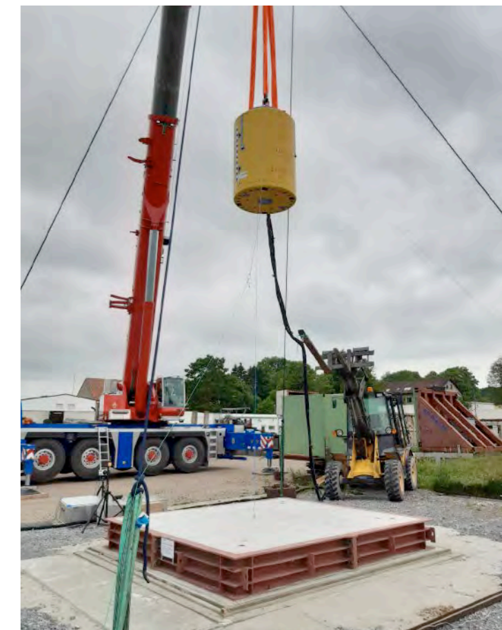
Produktkontrolle: Behälterbauartprüfung (Foto: GNS Gesellschaft für Nuklear-Service mbH)
