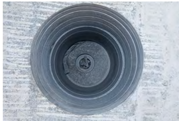
Testbohrungen: Hier werden Materialkennwerte für einen neuen Baustoff ermittelt. Es geht darum, Laborwerte zu bestätigen
