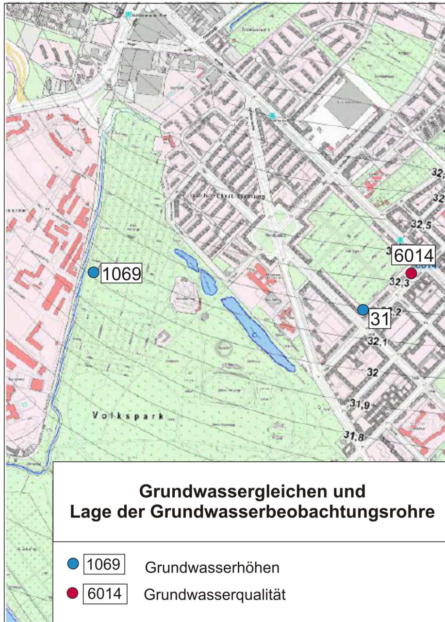
Abb. 7: Grundwassergleichen 2016 im Gebiet des Volksparks Rehberge und Lage der Grundwasserbeobachtungsrohre für Grundwasserganglinien und -qualität
