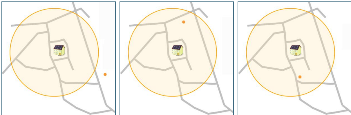
Abb. 2: Der Immissionsort liegt weiter als ca. 100 m von der Photovoltaikanlage entfernt.
