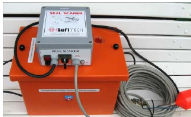
Abb. 7. “Seal Scarer”-Gerät (Firma Lofitech, Norwegen) mit Batterieeinheit, Kontrolleinheit mit Verstärker, Unterwasserkabel und akustischem Wandler (Foto: Kampfmittelbeseitigungsdienst - KBD, Niedersachsen).
