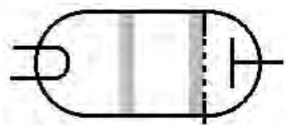
Abbildung 3: Schematische Darstellung der Anregungszonen (grau)
