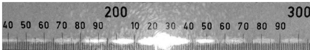
Abbildung 4: Beugung am Draht (Maßstab in mm)
