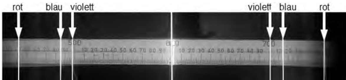
Abbildung 3: Wasserstoffspektrum durch das Gitter beobachtet (Skala in mm)
