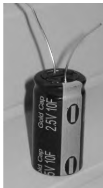
Abbildung 1: Kondensator mit der weißen Markierung des Minuspols
