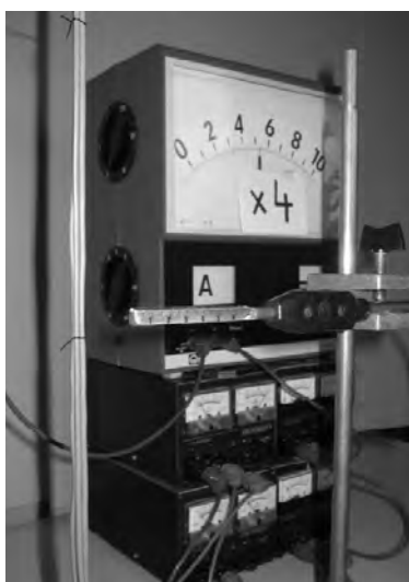
Detailansicht: Vier parallel verlaufende, lange, gerade Leiter sowie Hallsonde
