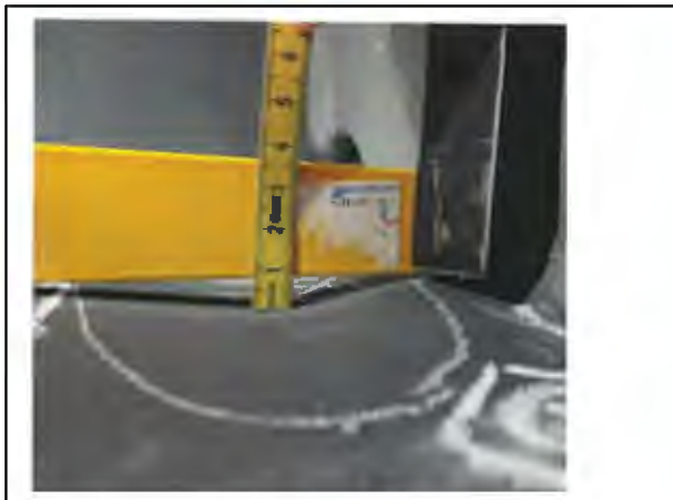
Bild 9: Beulverformung (T 34 D)
