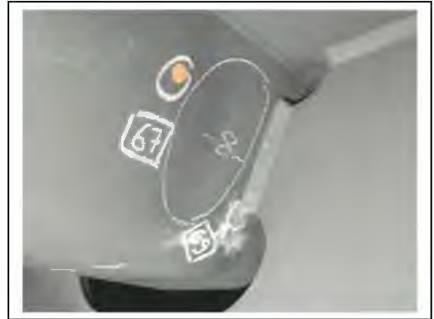
Bild 8: Beulverformung (T 34 D)
