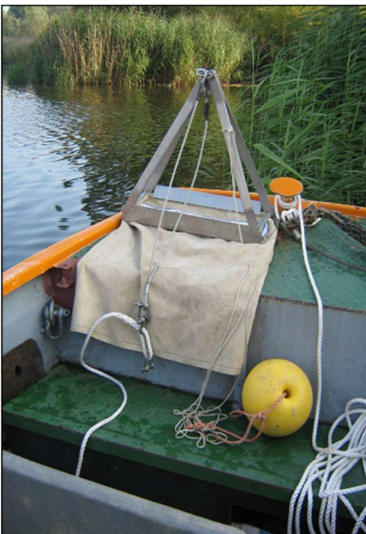
Abbildung 4: Dredge - modifiziertes Bodenschleppnetz zur Großmuschel- erfassung
