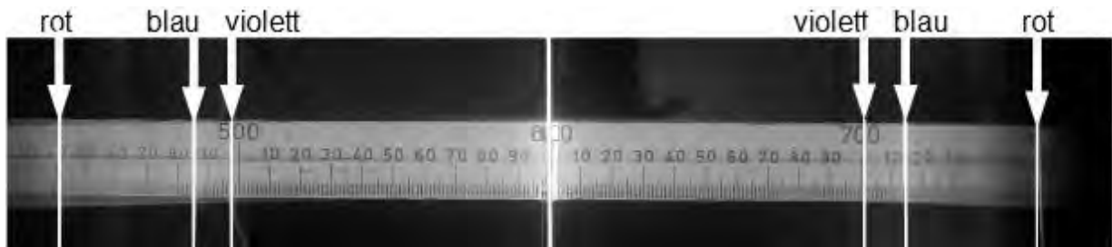
Abbildung 3: Wasserstoffspektrum durch das Gitter beobachtet (Skala in mm) (Quelle unbekannt, zur Optimierung der Abbildung nachbearbeitet, Farbausdruck siehe Zusatzblatt)
