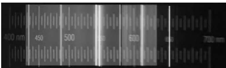
Abbildung 7: Spektrum der Energiesparlampe Typ B (zur Optimierung der SW-Abbildung nachbearbeitet, Farbausdruck siehe Zusatzblatt)
