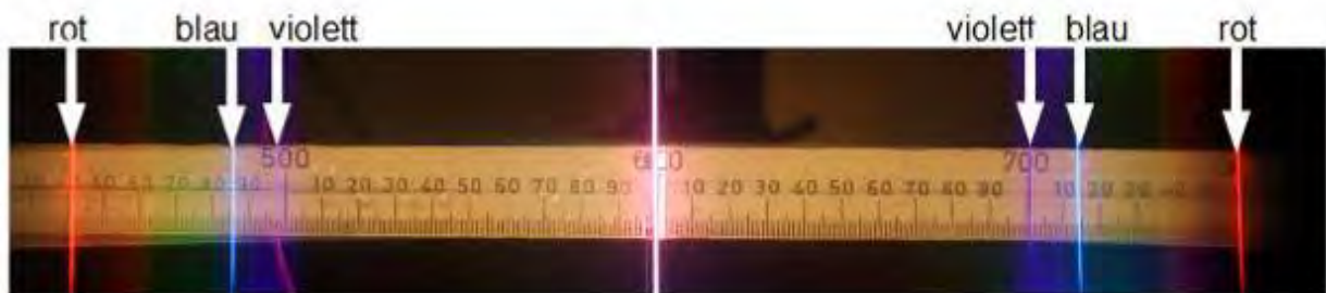
Abbildung 3: Wasserstoffspektrum durch das Gitter beobachtet (Skala in mm)
