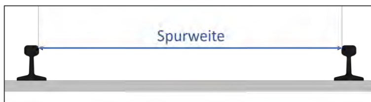
Abbildung 1: Spurweite von Bahngleisen
