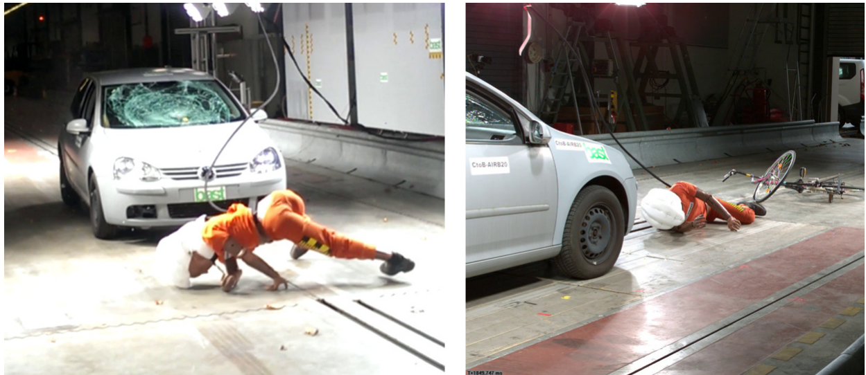
Abbildung 10: Sekundäraufprall auf der Fahrbahn (Standbilder aus Hochgeschwindigkeitsfilmen)
