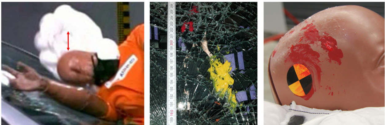
Abbildung 13: Fixierung des Kopfschutzsystems bei 40km/h und Kopfaufprallpunkt (rot)
