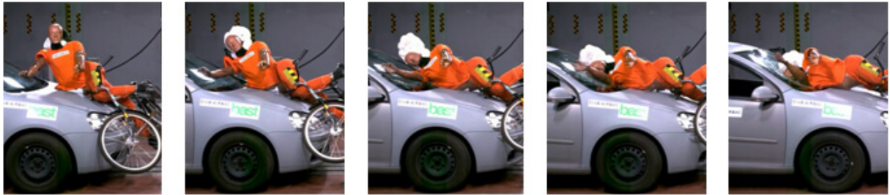
Abbildung 12: Kinematik und Abwicklung des Dummys bei Vollfahrzeugversuch mit 40 km/h
