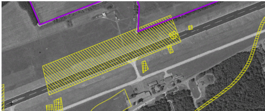
Abbildung 7-40: Gesprengte ehemalige Start- und Landebahn (Quelle: Historisch-genetische Kurzrekonstruktion /1/)
