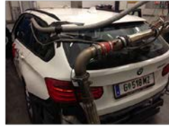
PEMS System von SNF in einem PKW
