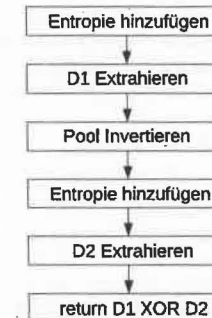
Abbildung 3.2: Extraktion von Zufallsmaterial aus dem Entropiepool.
