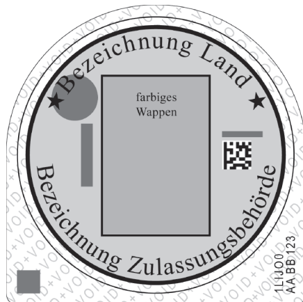
Abbildung 4: Plakettenträger mit Zerstörungsbild
